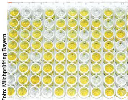
Das ELISA-Lesegerät wertet die Untersuchungsplatte aus. Positive Proben sind gelb, negative sind farblos.
